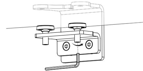
**7 FULLY TIGHTEN UPPER SCREWS**
